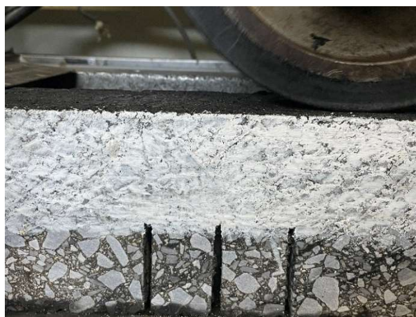
写真-2 ひび割れ貫通試験の状況
