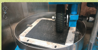
ねじり骨材飛散試験
