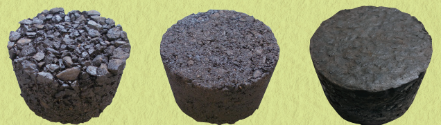
改質II型アスコン タフアスコン 半たわみ性舗装 油浸漬後(48時間)の供試体
