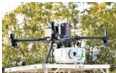
→グリーンレーザーを搭載したドローン
